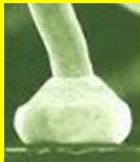
Bilde av kule trådsveising/Photo of a ball wire bond.
