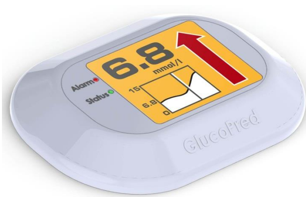
Fig 1: Conceptual sketch of the «GlucoPred» non-invasive blood glucose sensor. The sensor is to be strap mounted on the skin. / Konseptskisse for «GlucoPred» non-invasiv blodsukker sensor. Sensoren festes med en stropp mot huden.
