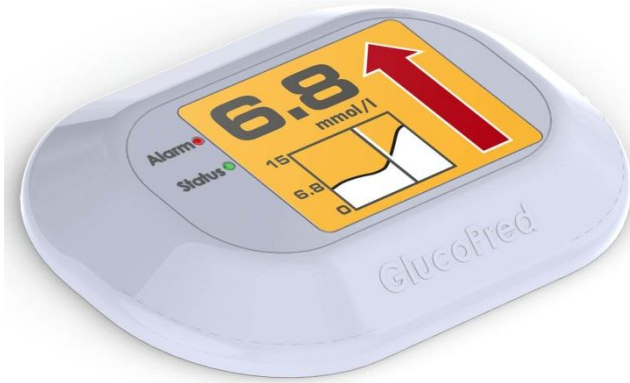
Fig 1: Conceptual sketch of the «GlucoPred» non-invasive blood glucose sensor. The sensor is to be strap mounted on the skin. / Konseptskisse for «GlucoPred» non-invasiv blodsukker sensor. Sensoren festes med en stropp mot huden.
